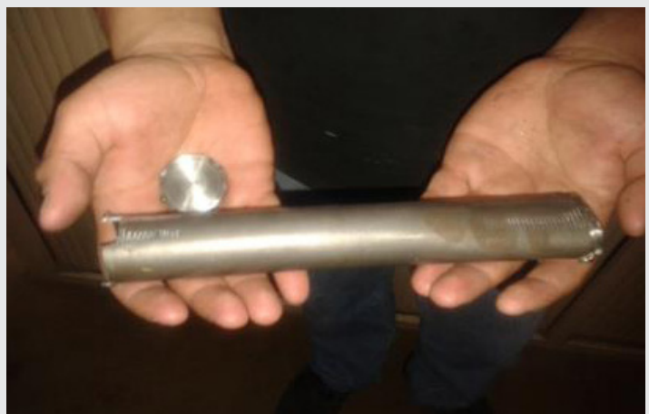
Fig. 2 Extremos aplastados por la máquina de tensión
